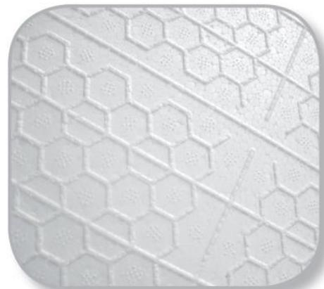
La superficie esterna ha una conformazione a nido d'ape per migliorare l'aggrappaggio del rasante, un "effetto righello" per facilitare il taglio a misura dei pannelli e sei bassorilievi ad interasse 20 cm per evidenziare la zona di fissaggio del rivestimento interno.
