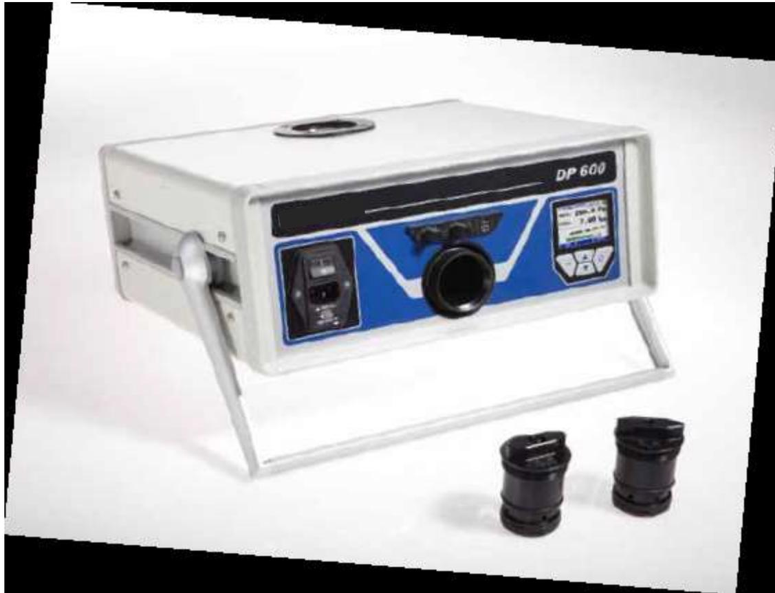
**Eeguire la prova di tenuta dell'impianto fumario**
