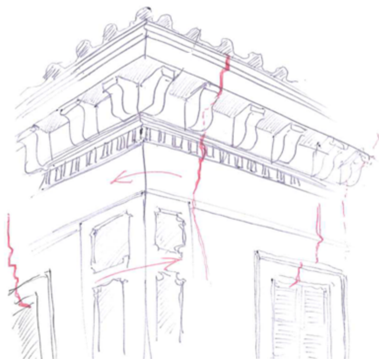
Schema di dissesto della parete laterale di valle per azioni complanari, con dettaglio del quadro fessurativo sommitale d'angolo
