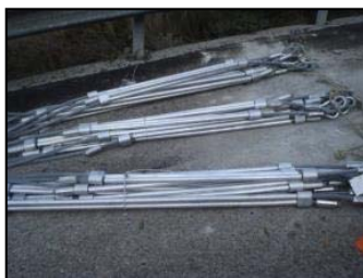
Dissipatori di energia
