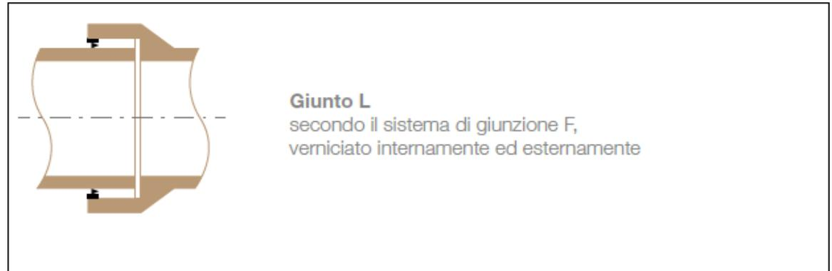
Il giunto L è composto da un anello appositamente sagomato inserito nella parte interna del bicchiere, il materiale della guarnizione è SBR e EPDM.
