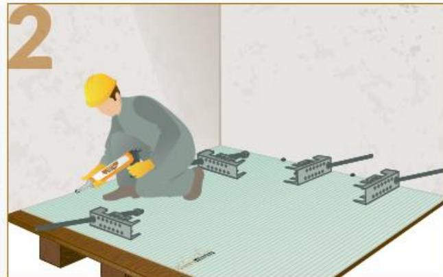
2 Pulire il foro (con pistola ad aria compressa, scovolino metallico, aspirazione), inserire l'eventuale bussola metallica (in presenza di muratura eterogenea) e riempire con Ancorante Chimico sino a circa i 3/5 della profondità posizionando la cartuccia dentro la "pistola" applicatrice.
