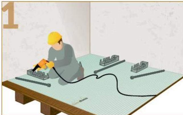
1 Posizionare il Prisma di base lungo l'intero perimetro del solaio (adeguatamente pulito e regolarizzato) secondo lo schema di posa previsto dal Progetto. Eseguire il foro a 45° nella muratura utilizzando la dima presente nel Connettore Perimetrale servendosi di un trapano tassellatore (punta  $\phi$  16 mm) per una lunghezza pari a circa 300 mm.
