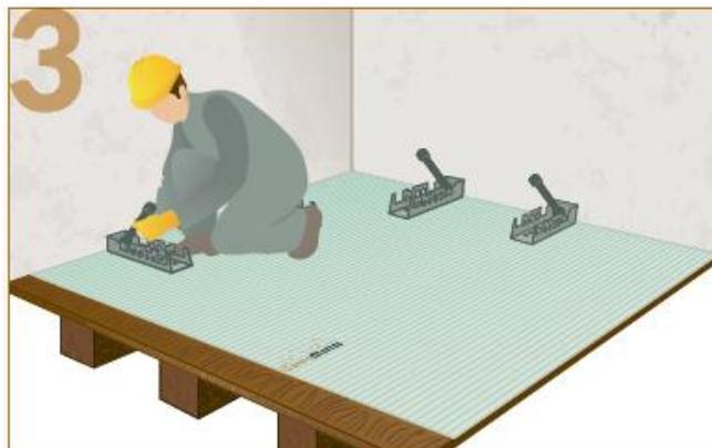
3 Inserire immediatamente il Tirante-Spinotto (completo del relativo Prisma) all'interno del foro resinato applicando un leggero movimento di rotazione.
