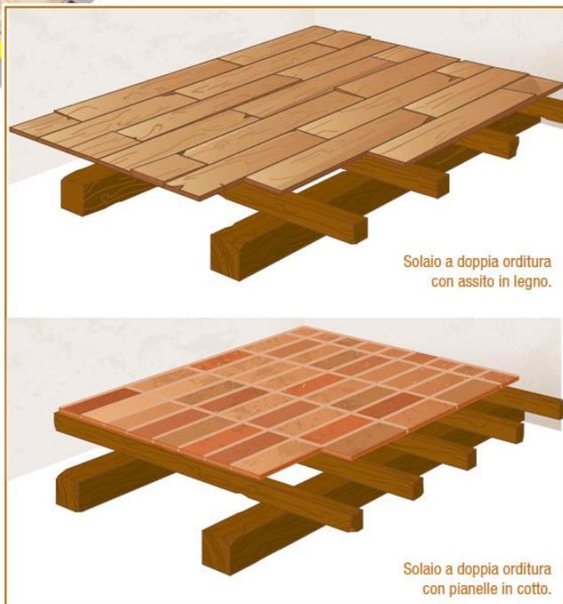
In genere travi principali di grandi dimensioni ad interasse di 3 – 4 metri e travetti secondari posti ad interasse di 30 – 60 cm
