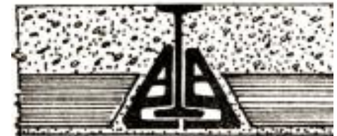
PARTICOLARE DI UNA TRAVE IN FERRO PROTETTA DA COPRI- FERRO
