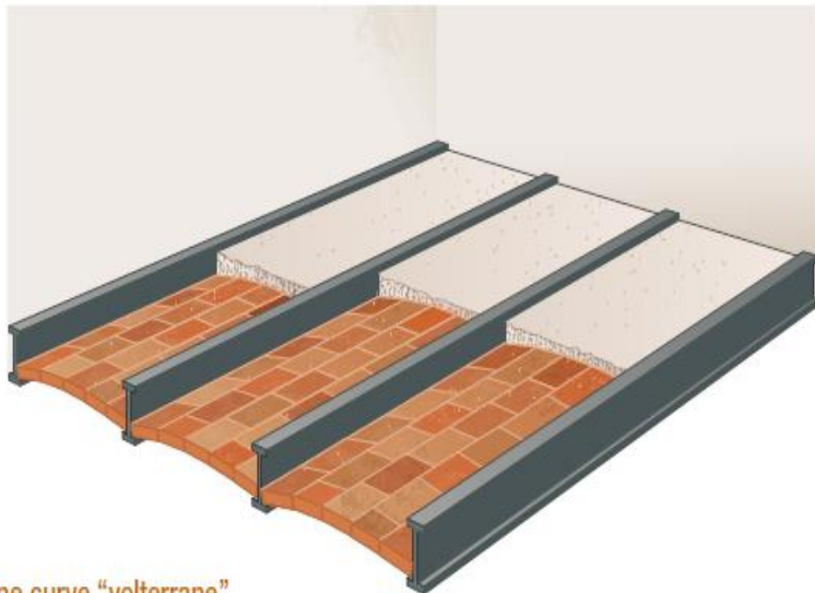
Voltine curve "volterrane".
